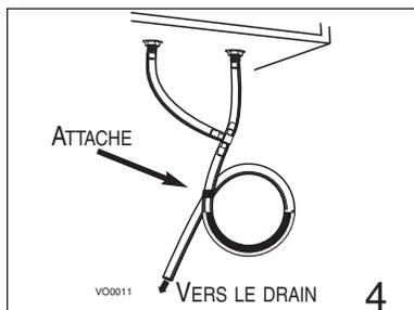
Faire une boucle dans le boyau pour retenir l'eau afin d'empêcher que l'appareil n'aspire les mauvaises odeurs du drain. S'assurer de faire la boucle EN DESSOUS du « T », tel qu'il est démontré. En cas de pression négative, cela évitera que l'eau ne remonte dans l'appareil. Raccorder le boyau au drain du sous-sol ou à un autre boyau raccordé au drain. S'assurer qu'il y ait une légère inclinaison pour l'écoulement.
