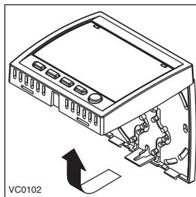
3. Passer le câble (4 fils) par l'ouverture centrale du socle et fixer le socle au mur à l'aide de vis (non incluses). Si nécessaire, insérer des chevilles de plastique (non incluses).
