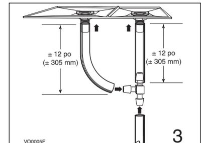
Couper 2 sections de boyau de plastique d'une longueur d'environ 12 po (305 mm) et les fixer à chaque raccord de drain. Relier les 2 petites sections au raccord en « T » et au boyau principal.
