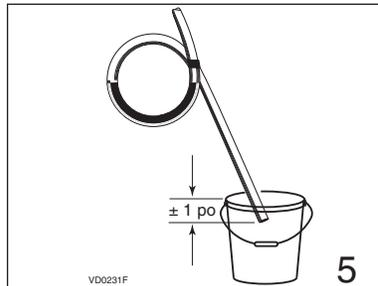
Si un seau est utilisé pour recueillir l'eau, placer le bout du boyau à environ 1 po du bord du seau afin d'éviter que l'eau ne remonte dans l'appareil.
