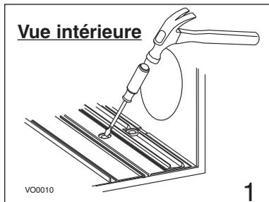
Pour installer les raccords de drain, défoncer les deux ouvertures préamorcées situées au bas de l'appareil.
