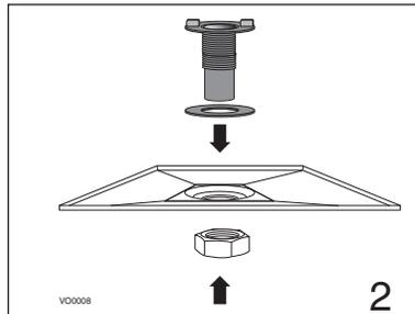
Afin d'éviter d'altérer le bac de récupération d'eau, serrer à la main les 2 raccords de drain en plastique à l'aide des joints d'étanchéité, des rondelles et des écrous.
