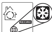
CETTE ICÔNE APPARAÎT LORSQUE L'APPAREIL EST EN MODE PROTECTION. CE MODE SPÉCIAL A ÉTÉ CRÉÉ POUR PROTÉGER L'APPAREIL DE VENTILATION CONTRE DES CONDITIONS SPÉCIFIQUES (EX.: TEMPÉRATURE EXTÉRIEURE PLUS FROIDE QUE -25 °C). IL N'Y A AUCUNE ACTION À ENTREPRENDRE LORSQUE CETTE ICÔNE APPARAÎT, ELLE DISPARAÎTRA D'ELLE-MÊME.
