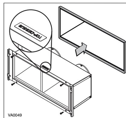
ASSEMBLER LA GRILLE À LA BOUCHE TANDEM DE MÉTAL À L'AIDE DES VIS N° 8 X 3/8 PO RETIRÉES PRÉCÉDEMMENT ET DE 2 AUTRES VIS N° 8 X 3/8 PO INCLUSES DANS LE SAC DE PIÈCES. SCELLER LE POURTOUR AVEC DU CALFEUTRE.
