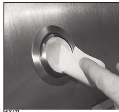
3. Remplacer par une ampoule halogène de type JC, 12 V, 20 W max, à culot G-4.
