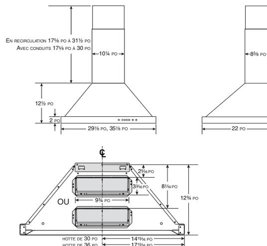
Dans le cas d'une installation horizontale, afin de faciliter l'adaptation de la hotte à un trou déjà existant, l'ouverture pour l'évacuation horizontale peut être située en haut OU en bas, à l'arrière de la hotte.
